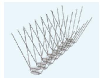
**PIXX® Duo T-Träger** ist speziell zur Vogelabwehr unter T-Trägern konzipiert und aus rostfreiem Edelstahldraht, Werkstoff-Nr. 1.4301, hergestellt. Die Basisleiste ist 17,5 mm breit und zu Anbringungszwecken 10-fach gelocht. Der Abstand der Spikes auf der Basisleiste beträgt 50 mm. Die Drahtstärke ist  $\varnothing$  1,6 mm. Die gesamte Leiste ist 1 m lang.
