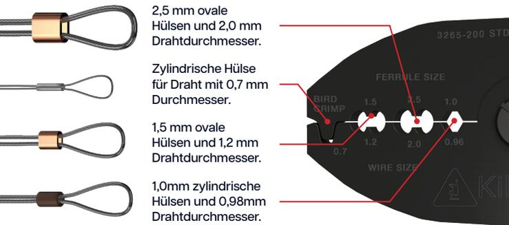
**DÜNN** **DIESES WERKZEUG IST FÜR DÜNNWANDIGE 1,5 MM HÜLSEN VORGESEHEN; BEI DICKWANDIGEN HÜLSEN KANN DAS WERKZEUG BLOCKIEREN. IN DIESEM FALL IST DIE ANLEITUNG ZUM LÖSEN DER ZANGE ZU BEACHTEN.**
